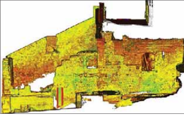
Figura 9. Alzado generado a partir del escáner láser y tratamiento Cyclone.
