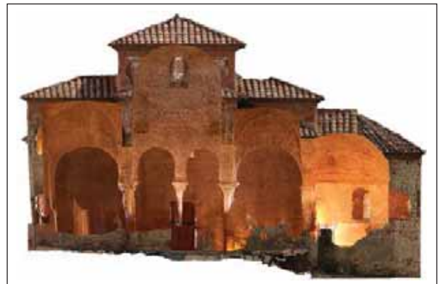
Figura 8. Sección y alzado combinado de la iglesia de Sant Miquel de Terrassa (Archivo ICAC-UDG).
