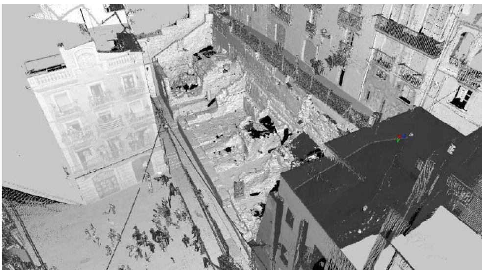
Figura 7. Nube de puntos con valores lumínicos («sombreado») en gris. Circo romano de Tarragona, área de Sedassos.
