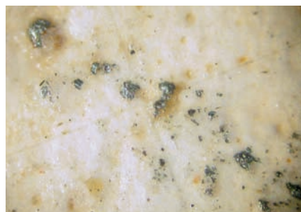
Fig. 7. Detall, ampliat a 60 X, d'una línia feta amb un estil tou, probablement de plom o d'un aliatge de plom-estany. S'observa la direcció seguida pel traç de color gris brillant. Imatge obtinguda amb un microscopi portàtil (objectiu PEAK 10 X / 6 - NA O,15) sobre la preparació del frontal / Detalle, ampliado a 60 X, de una línea hecha con un estilo blando, probablemente de plomo o de una aleación de plomo-estaño. Se observa la dirección seguida por el trazo de color gris brillante. Imagen obtenida con un microscopio portátil (objetivo PEAK 10 X / 6 - NA O,15) sobre la preparación del frontal.
