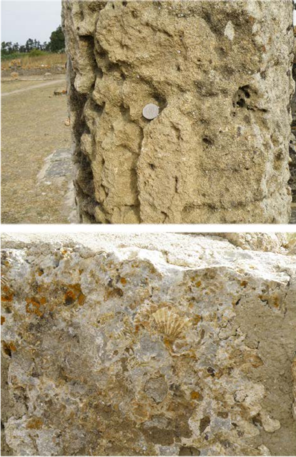
Figura 10. Arriba, calcarenita procedente de la costa atlántica y litología predominante en las construcciones de Banasa . Abajo, caliza de facies marina procedente del SE de la región.
