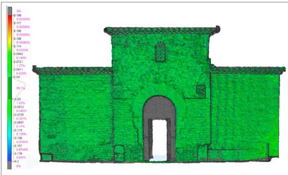
Figura 4. Comparativa de la desviación entre un alzado fotogramétrico y el obtenido mediante escáner láser (Sant Miquel de Terrassa) (Archivo ICAC-UDG).
