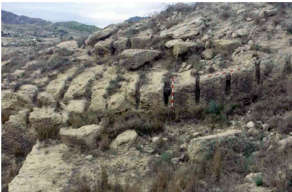
Figura 7. Canteras de arenisca de Canteras (Cartagena). Hilada de bloques en fase de extracción mediante ranuras longitudinales. Fuente: J. A. Antolíns.
