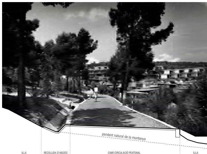
Figura 3.41 Secció tipus dels camins peatonals "trazados en estilo rústico" Font: autor sobre base de la fotografia de Foto Raymond (AHT).
