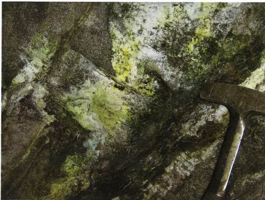
Figura 3.1. Eflorescències i crostes de minerals supergènics d'urani, de colors groguencs, de formació molt recent, desenvolupats a les parets de la galeria superior de la mina Eureka. Fotografia de Montgarri Castillo.
