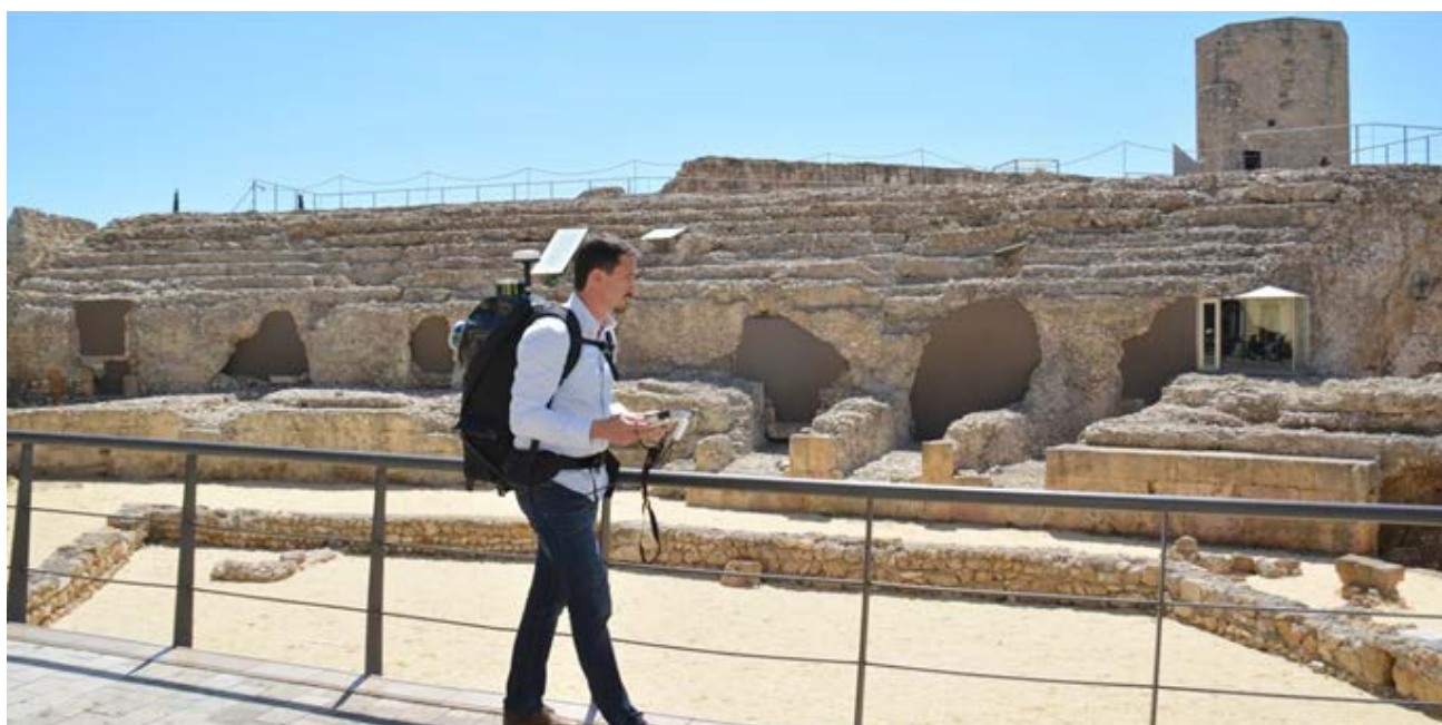
FIGURA 1. Escaneo del circo y su entorno mediante el Mobile Mapping (Pegasus Backpack).
