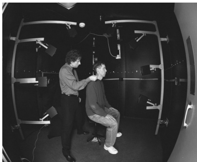
Il·lustració 13: Mesura de la HRIR en una sala anecoica (Geluso & Roginska, 2018).
