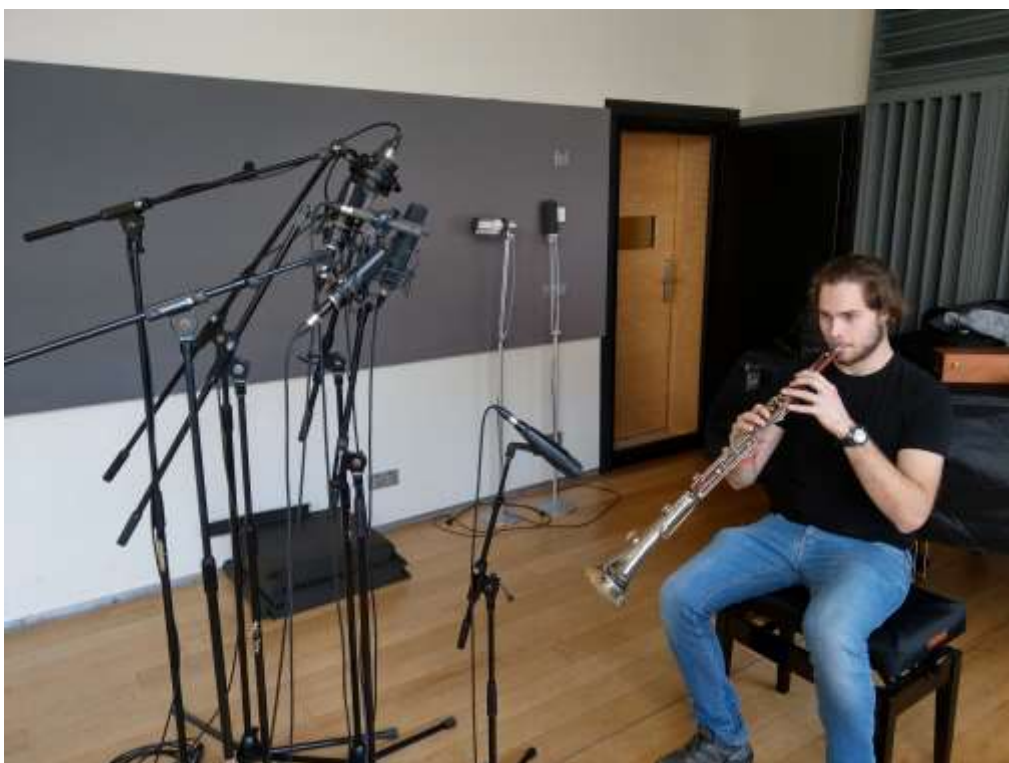
Imatge 1.2: micròfons col·locats en diagonal ascendent a 1m.
