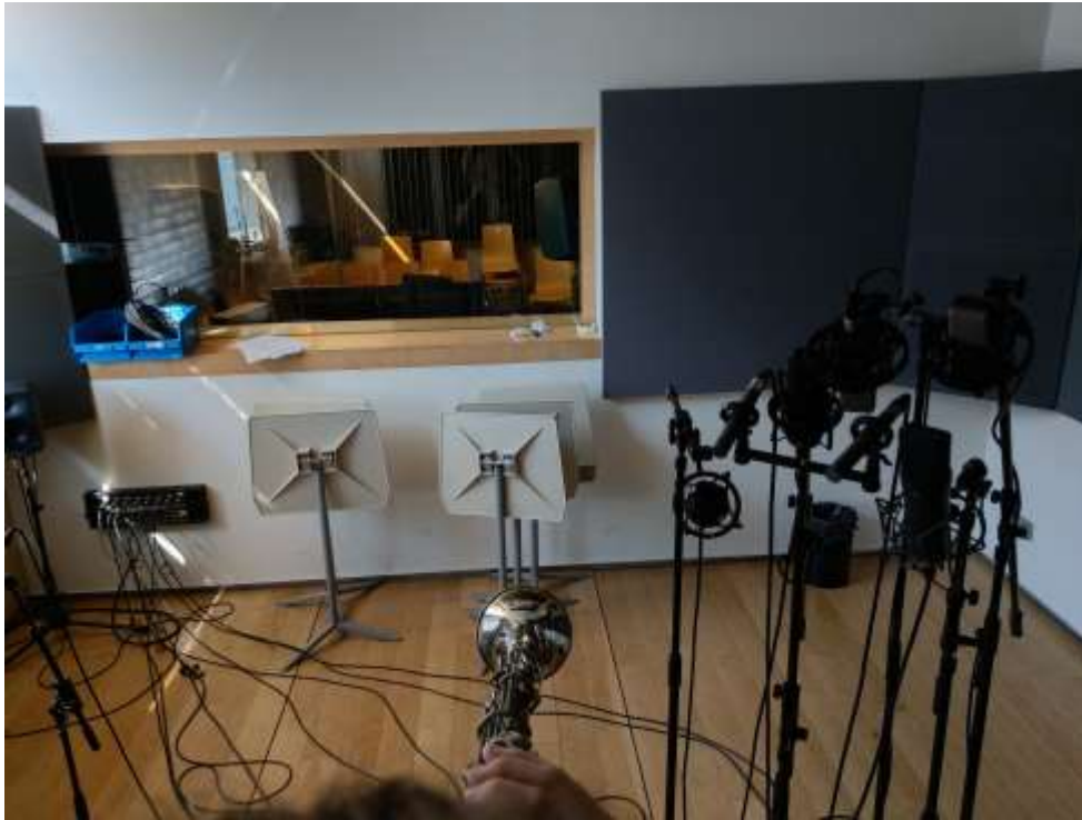
Imatge 1.3: micròfons col·locats en diagonal ascendent a 40-50cm
