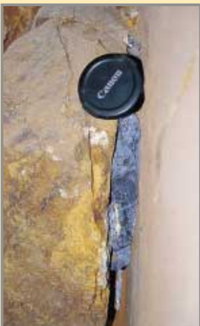
Detalle, "in situ", de una veta de galena de hoja, en la mina Regia Antigua, en 1998. Foto: G. García.
