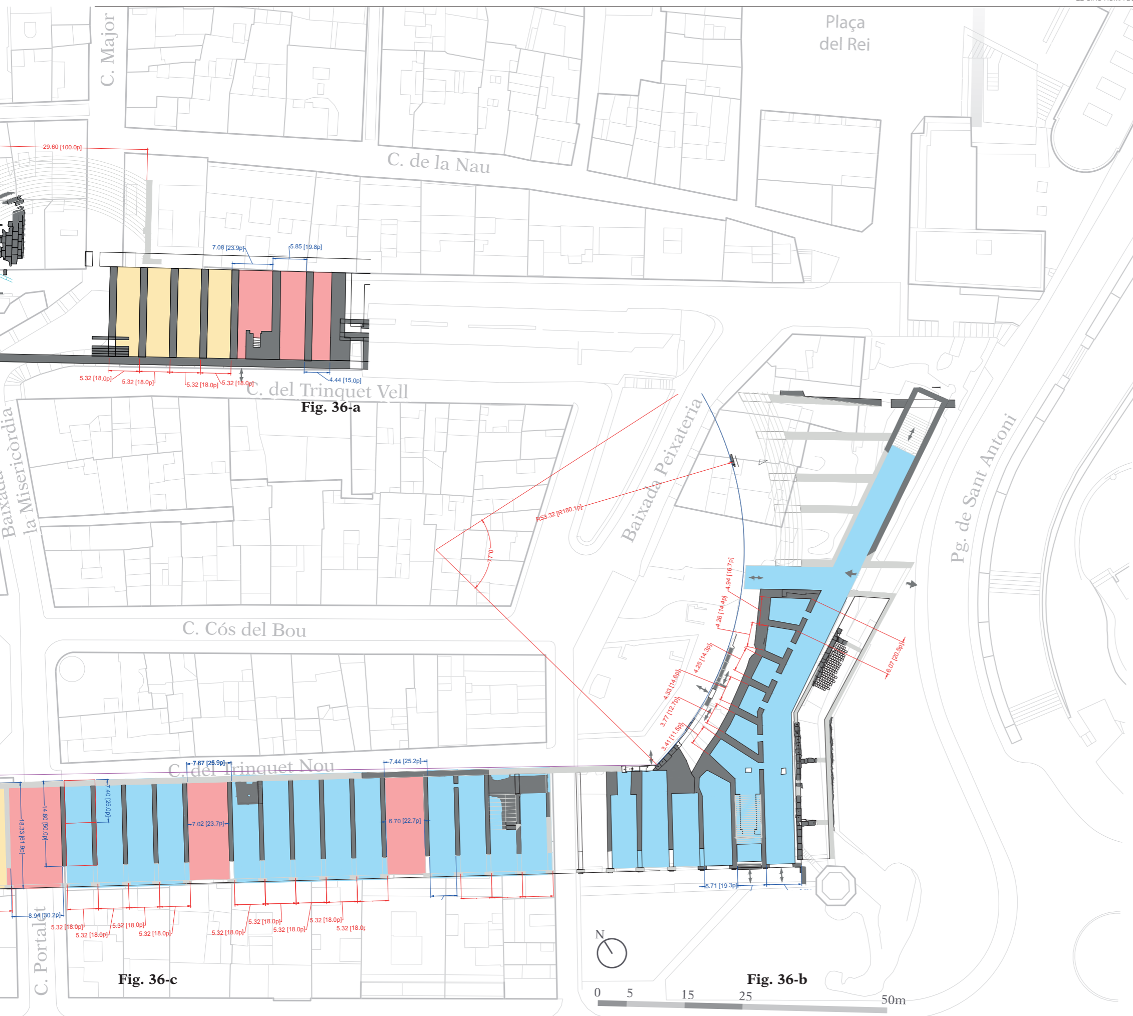
Figura 36. Modulació i ordenació geomètrica del Circ de Tarragona. Diferenciació entre les modulacions d'elles graderies Nord i Sud. Modulació i ordenació geomètrica del Circo de Tarragona. Diferenciació entre las modulaciones de la gradería Norte y Sur.
