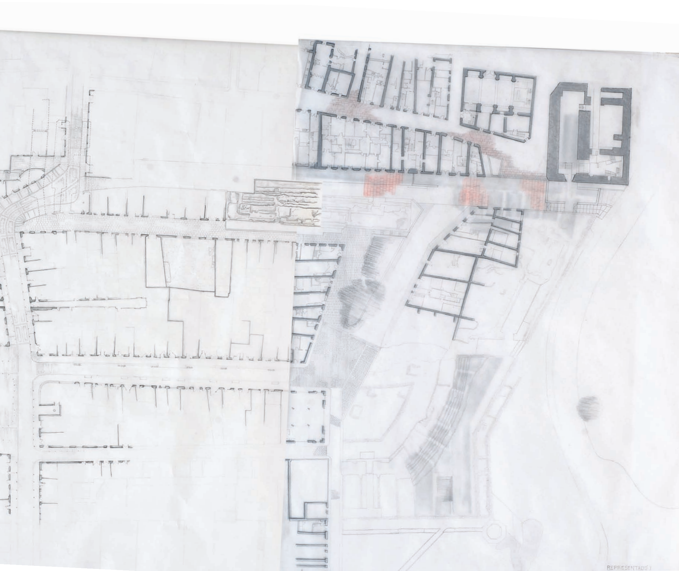
Figura 100. Planimetria del Circ romà de Tarragona fet a partir de l'aixecament topogràfic i dibuix a mà. Treball realitzat pels alumnes de l'assignatura de Representació del Patrimoni (curs 2016-2017). Planimetría del Circo romano de Tarragona hecha a partir del levantamiento topográfico y el dibujo a mano. Trabajo realizado por los alumnos de la asignatura de Representación del Patrimonio.
