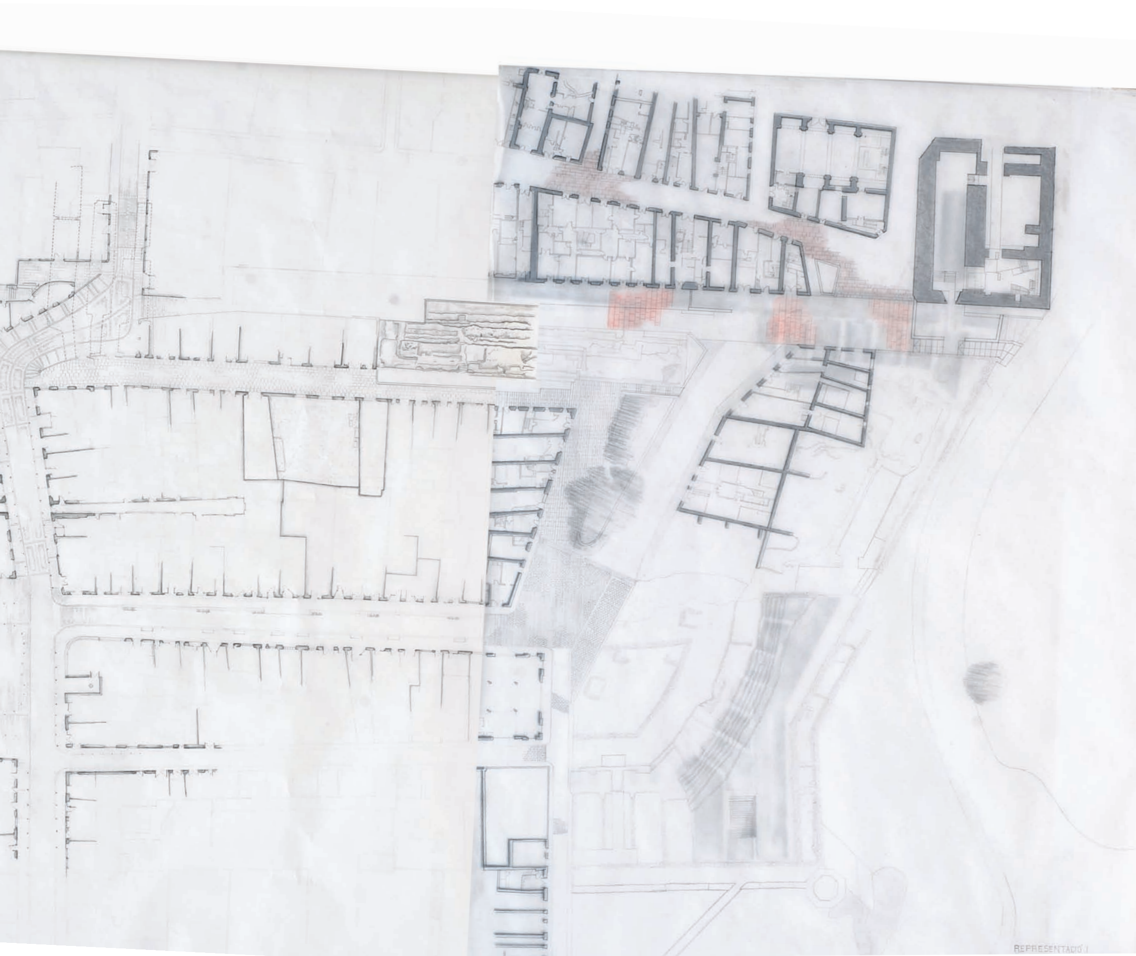
Figura 100. Planimetria del Circ romà de Tarragona fet a partir de l'aixecament topogràfic i dibuix a mà. Treball realitzat pels alumnes de l'assignatura de Representació del Patrimoni (curs 2016-2017). Planimetría del Circo romano de Tarragona hecha a partir del levantamiento topográfico y el dibujo a mano. Trabajo realizado por los alumnos de la asignatura de Representación del Patrimonio.
