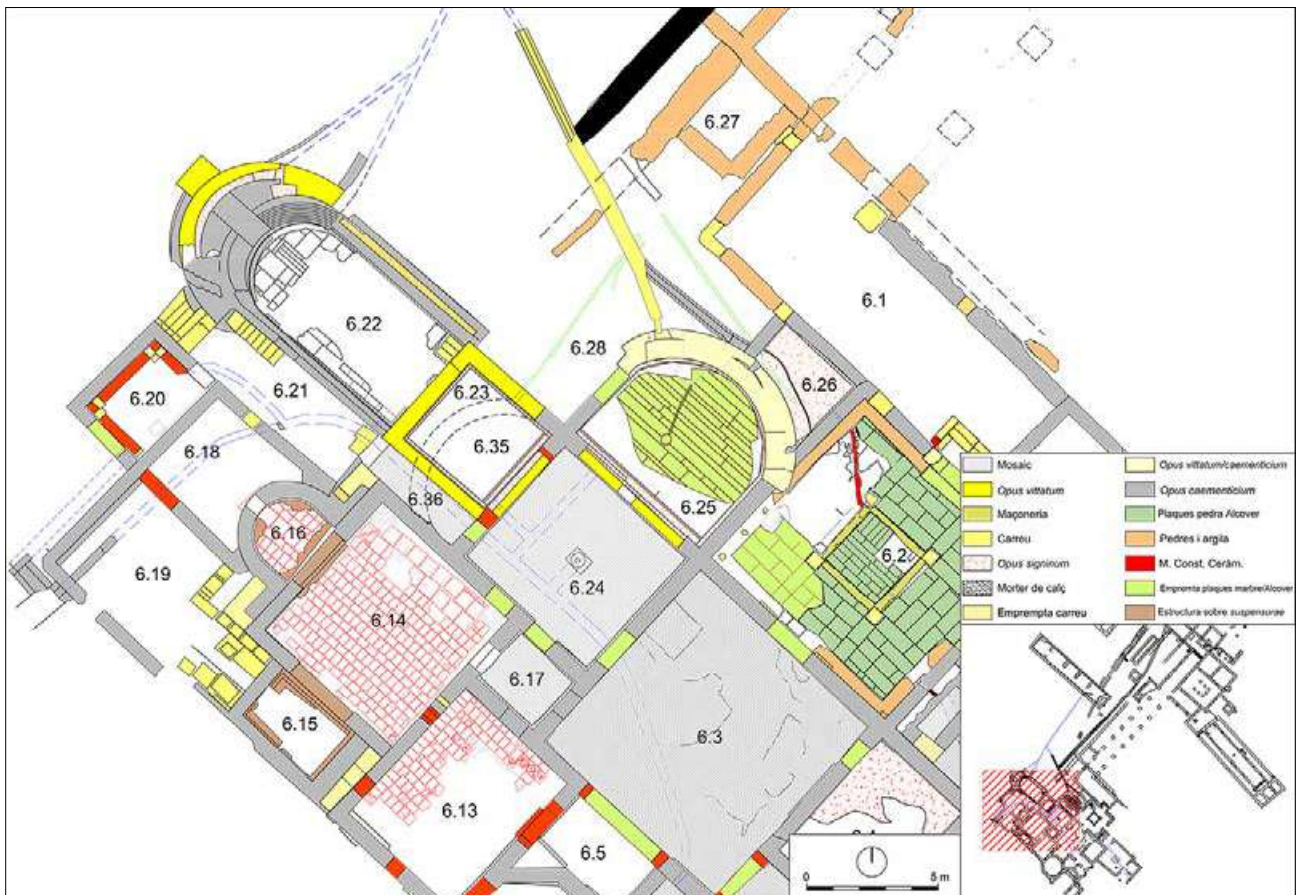
Figura 2.102. Planta parcial de l'extrem occidental dels banys meridionals (6) indicant tècniques i materials (J. Sánchez/Arxiu MNAT).
