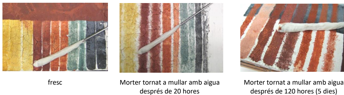
Figura 2.5. Imatges dels resultats de les proves mecàniques d'adhesió dels pigments al morter.
